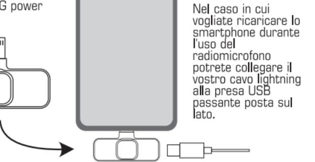
Nel caso in cui vogliate ricaricare lo smartphone durante l'uso del radiomicrofono potrete collegare il vostro cavo lightning alla presa USB passante posta sul lato.
