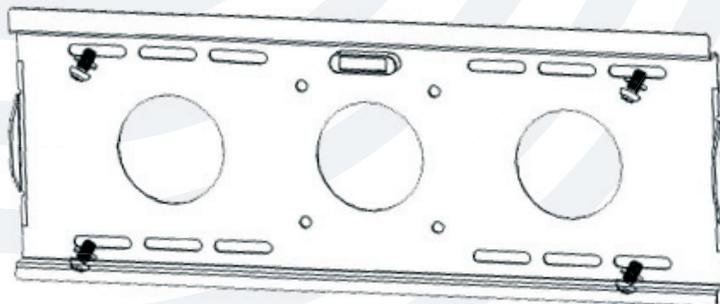
**3)** Applicate i pomelli alle viti delle staffe regolabili svitando prima il due bulloni attualmente fissati. Appoggiate delicatamente il vostro schermo LCD a plasma su una superficie piana magari posizionando prima un telo che prevenga righe o danneggiamenti allo schermo. Applicate le due staffe verticali orientabili allo schermo facendo combaciare i fori con quelli sul retro dello schermo.
